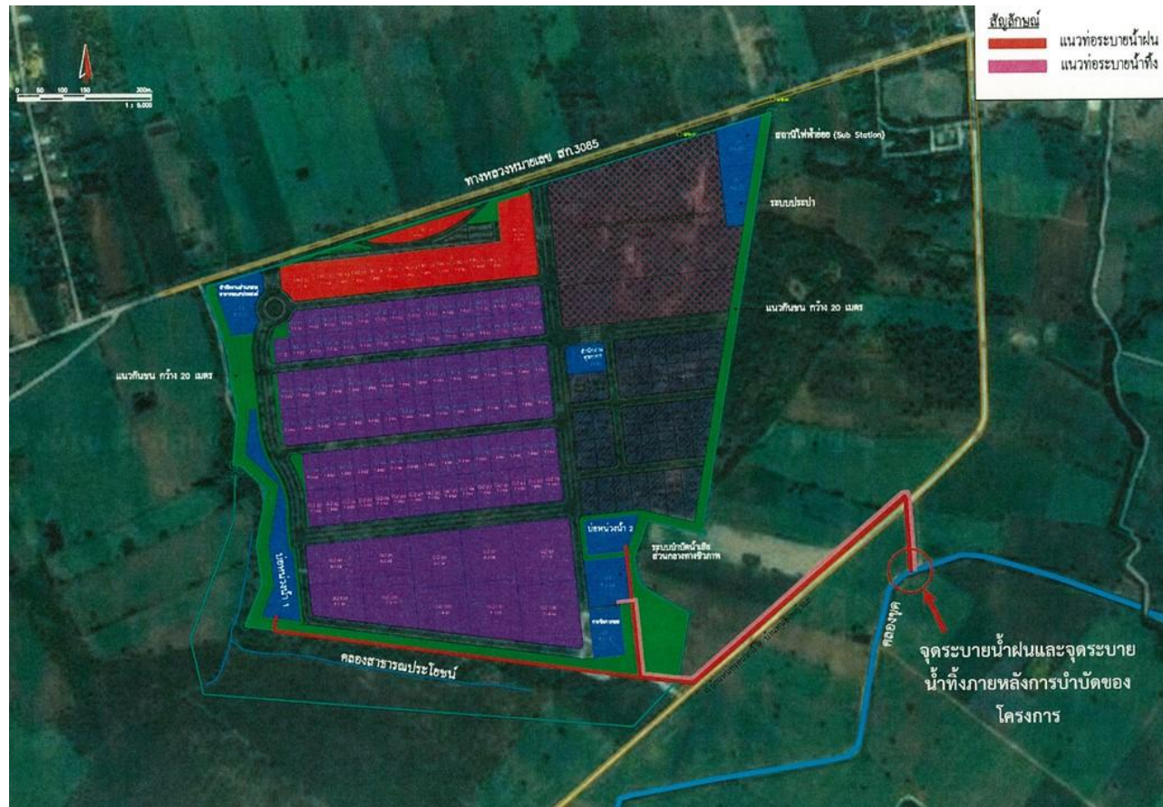
รูปที่ 1.4.4-3 จุดระบายน้ำฝนและจุดระบายน้ำทิ้ง
